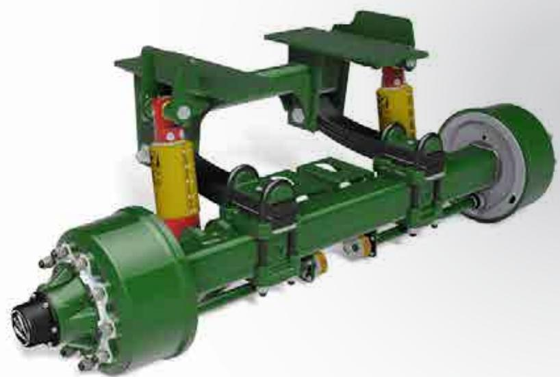
Hydroevo è una sospensione idraulica a bracci indipendenti. Le ruote sono incollate al terreno in tutte le condizioni di servizio: stabilità senza paragoni in curva e frenata sicura anche su terreni irregolari. Ideale per le macchine operatrici da cava o per le agricole soggette a forti squilibri di carico.
